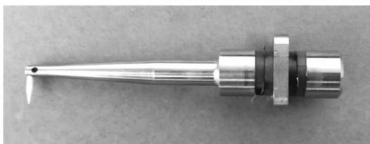
图 8 多向换能器实物图
